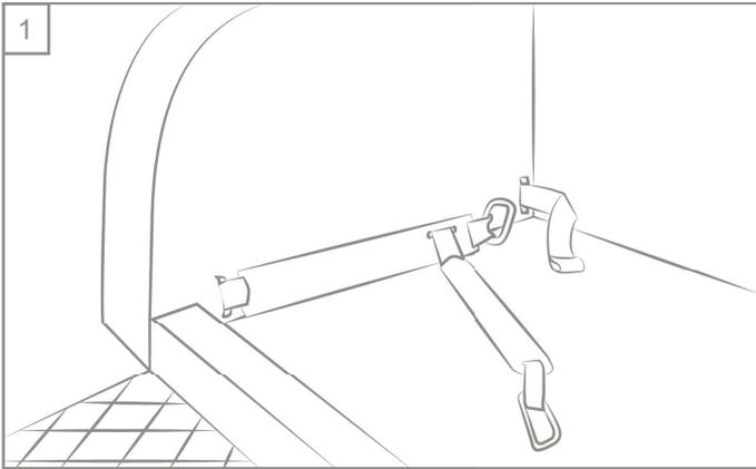
**1.** Den Karabinerhaken vom Gurtsystem lösen. Anschließend das lange Ende mit der Schlaufe durch den vorderen und hinteren Schlitz des Cargo ziehen.
